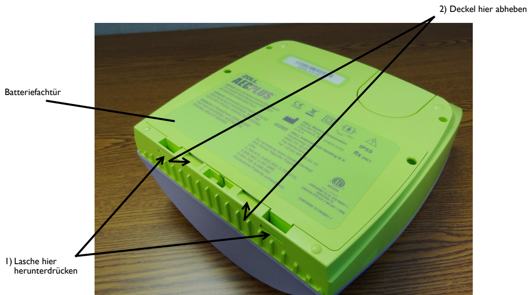
Abbildung 6: Batteriefachtür abnehmen
